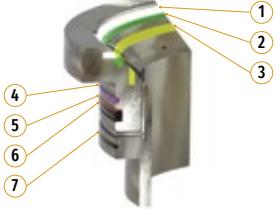
> SPE con Delta ring, anello elastico metallico, inserto termoplastico
